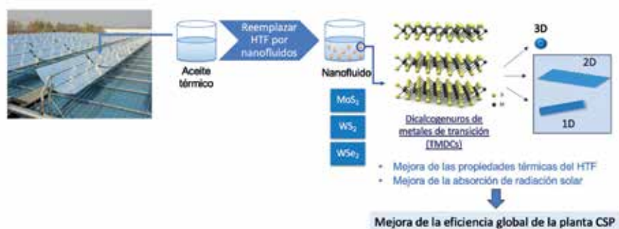
Resumen gráfico de la temática de la Tesis Doctoral: estudio de nanofluidos basados en diferentes morfologías de TMDCs para ser usados como fluidos transferentes de calor en las centrales solares basadas en colectores cilíndrico-parabólicos.
